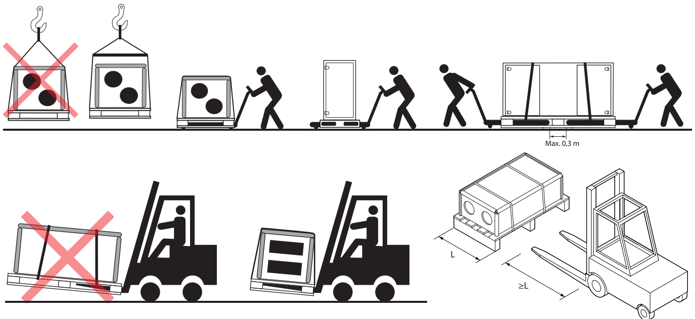
Мал. 5. Приклади транспортування за допомогою крана, автонавантажувача та технологічного візка
